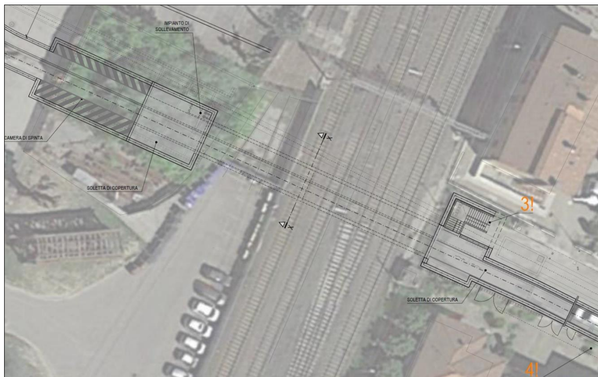
Figura 1-6: stralcio planimetrico della soluzione 3 (sottopasso ciclo-pedonale).
