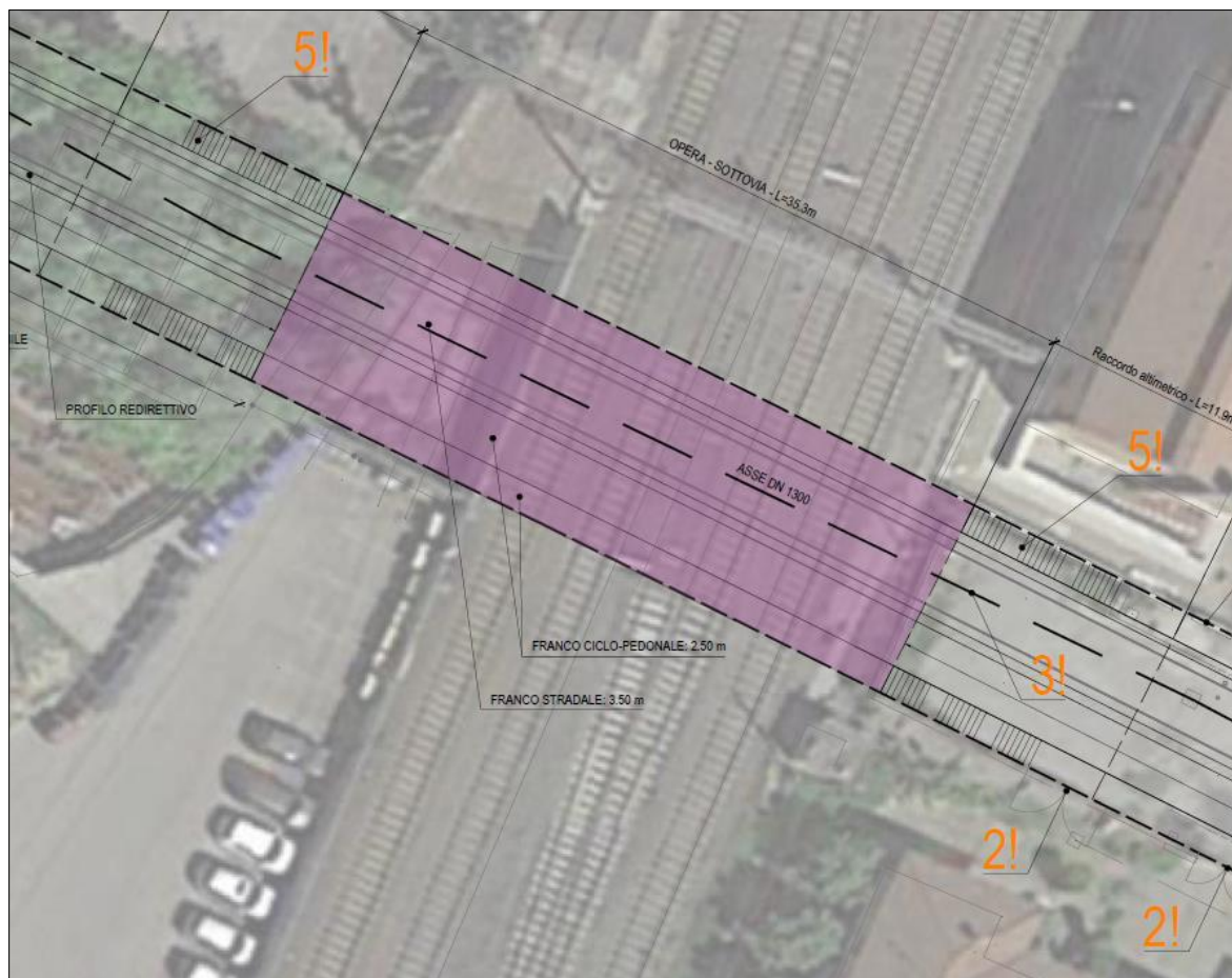
Figura 1-4: stralcio planimetrico della soluzione 2 (carrabile a senso unico).
